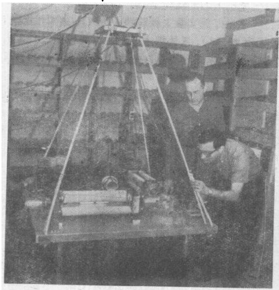
图 10.13 使用两台气体激光器进行相对论性光学实验的一个精密装置。
