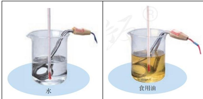
实验：相同质量的水和食用油，同样的加热方式，用加热时间表示物体吸收的热量（转换的思想）。我们可以采取两种方式验证，一是让水和食用油升高相同的温度，比较加热时间；二是加热相同的时间，即让二者吸收相同的热量，比较水和食用油升高的温度。
